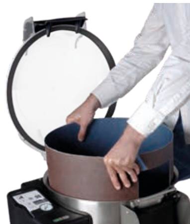
PARETE ABRASIVA SU TUTTI I MODELLI FACILMENTE SMONTABILE PER UNA CORRETTA PULIZIA SENZA L'UTILIZZO DI UTENSILI
