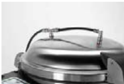
UGELLI PER LAVAGGIO TARTUFI TRUFFLE WASH NOZZLES
